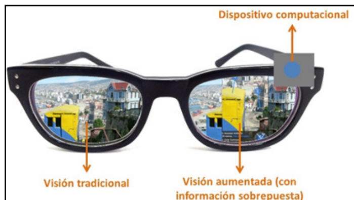
Esquema 2. Explicación del funcionamiento de las lentes inteligentes con realidad aumentada (fuente: elaboración propia).
